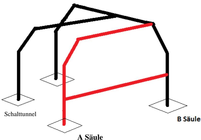
Flankenschutz ist notwendig, wenn keine Stahlplatte außen zwischen A + B-Säule verbaut wird
